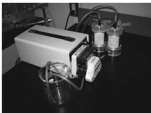
Photo. 1 カラム試験における供試体の養生 カラムは直径 4.5cm、高さ 8.5cm の円筒形であり、下部のバルブからリン酸水溶液を 15ml/min の速度で注入し、養生後に上部のバルブから溶液を回収する。
